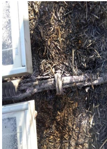
（中）焼損した PV 線
