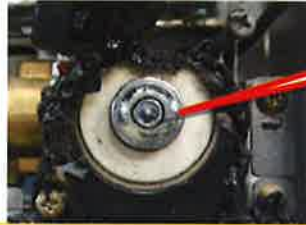
付着した樹脂を除去した状態
