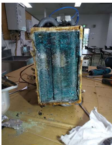
【熱交換器錆（緑青）状況】
