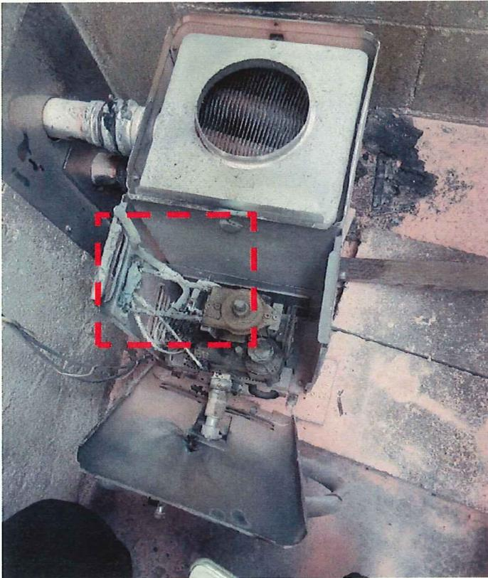
配線焼損箇所（破線部拡大）
