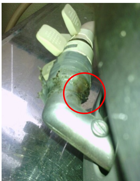
【焼損箇所(ゴム管継手部巻きビニールテープ)】
