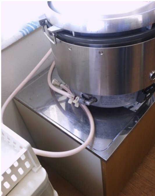
【焼損箇所(ゴム管継手部巻きビニールテープ)】
