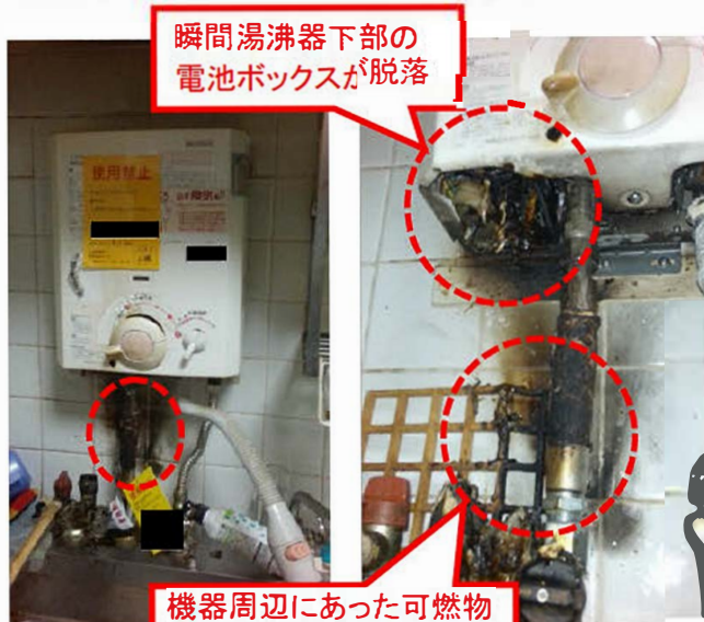
【瞬間湯沸器、強化ガスホース焼損状況】
