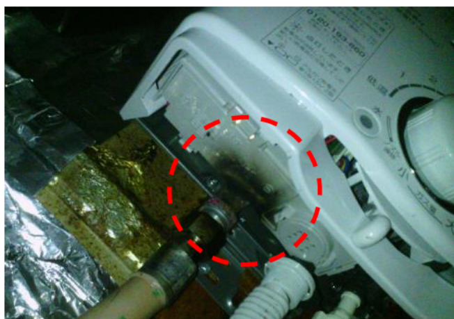
【焼損箇所：瞬間湯沸器下面（電池カバー付近）、強化ガスホース（金属継手部）】
