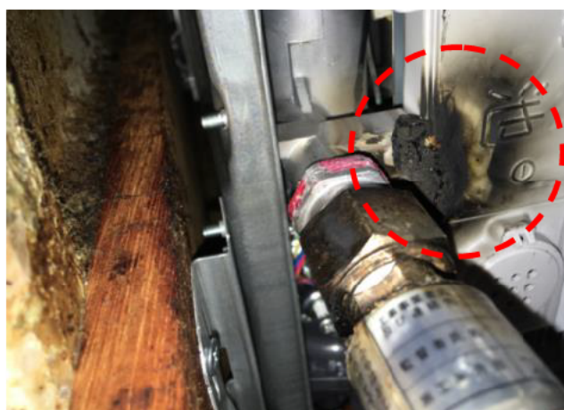
【焼損箇所：瞬間湯沸器下面（電池カバー付近）、強化ガスホース（金属継手部）】
