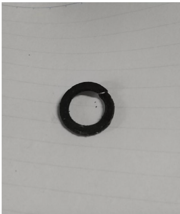
【接続具パッキン（割れ発生状況）】
