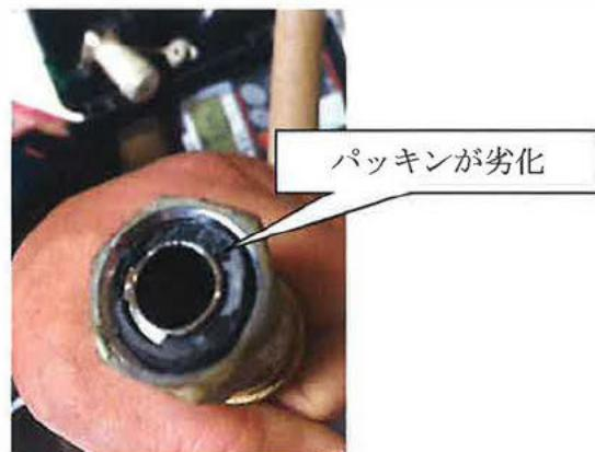
→小型湯沸器と強化ガスホースの接続部でガスが漏洩しており、強化ガスホースの接続部締め込みが緩い状態となっていること、また、強化ガスホース接続部の内部にあるパッキンが劣化していることを確認
