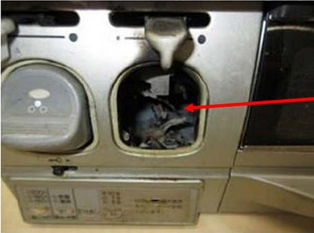
点火操作部が熔融し、機器内に脱落している状態
