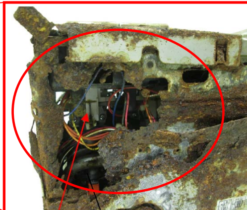
煮こぼれによる腐食で 底面に穴開きを確認
