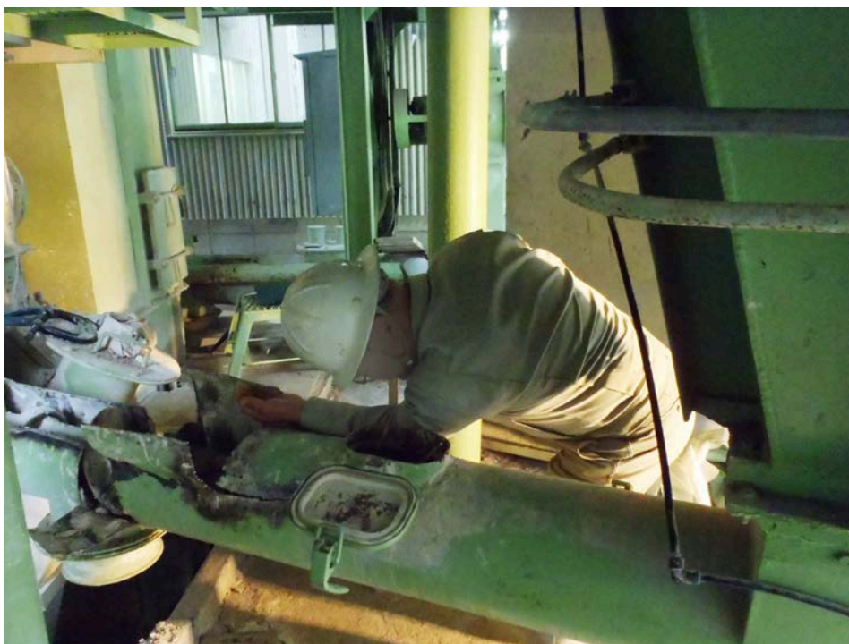
スクリーコンベアの点検口 (通常は、 \phi 5 mmの鉄線の格子の上にエキスパンドメタルを設置している。)
