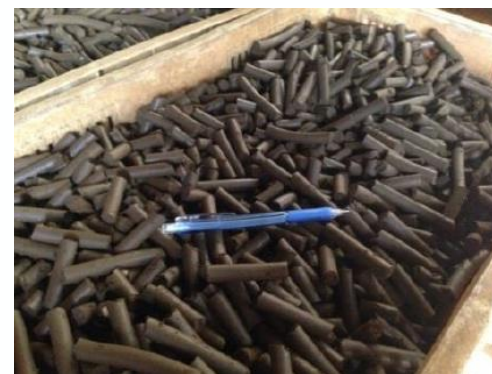
製造直後の脱硫化水素剤
