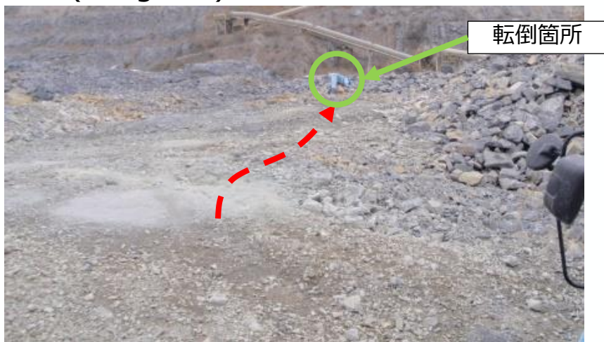
罹災箇所遠景（赤破線は運搬経路）
