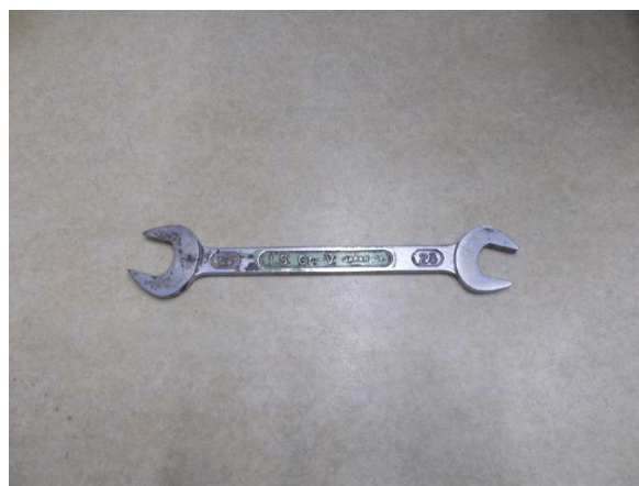
写真4 罹災者が使用していたスパナ （全長：275mm）
